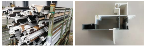
左は樹脂窓の製造過程で発生する樹脂端材。右は樹脂端材を再利用した樹脂型材(灰色部分がリサイクル材)
