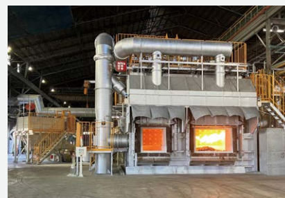
四国製造所のリサイクル炉。 左奥は材料の自動投入機
