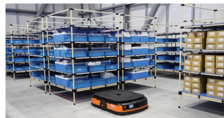
首都圏DCで稼働する棚搬送型ロボット
