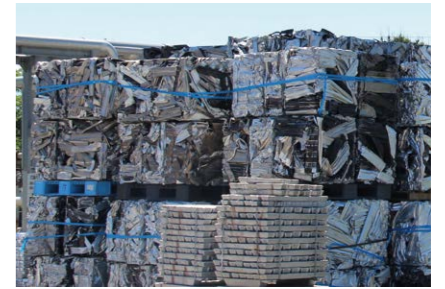
アルミは「電気の缶詰」とも呼ばれ、ボーキサイト等の原材料から精製する際に電気分解による大量の電力が必要で、一方、リサイクルにおいては少量のエネルギーで再溶解することができるため、アルミのリサイクルはCO 2 排出削減に非常に重要な役割を果たします。
