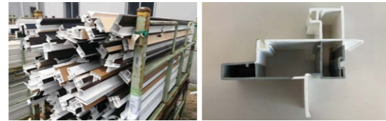
左は樹脂窓の製造過程で発生する樹脂端材。右は樹脂端材を再利用した樹脂形材(灰色部分がリサイクル材)
