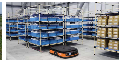
首都圏DCで稼働する棚搬送型ロボット
