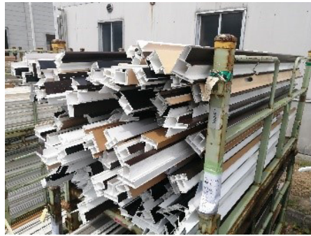
(左) 樹脂窓の製造過程で発生する樹脂端材 (右) 樹脂端材から得た再生原料を使用した樹脂形材 (灰色部分がリサイクル材)
